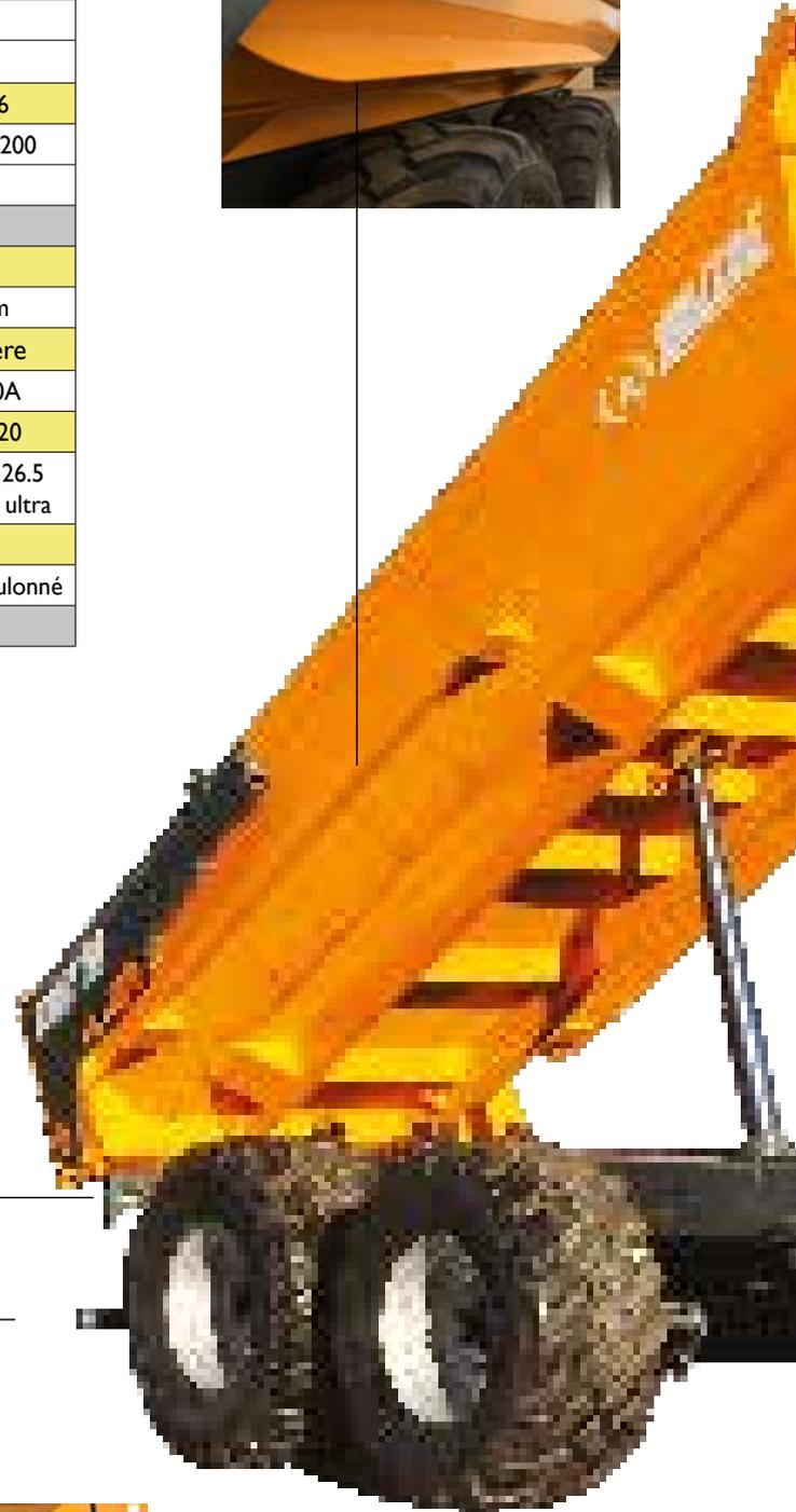
Les modèles de bennes de travaux lourds Dump ont été conçus pour des travaux rudes. Leur conception robuste, côtés 6mm, fond 8mm en acier type HARDOX augmentent la résistance et la durée dans le temps. La benne Dump est équipée en standard d'un boggie spécial TP. Ce train roulant garantissent un grand confort de roulage dans les terrains accidentés.
