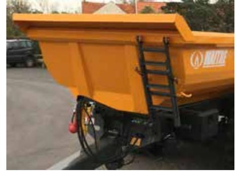
Echelle d'accès repliable
