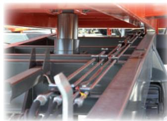
Système hydraulique en tuyau rigide
